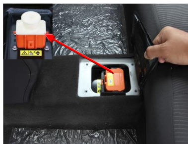
维修开关及 防护堵盖
